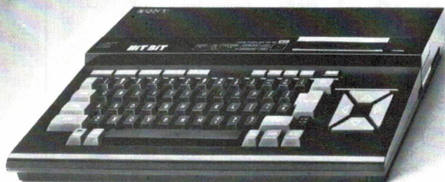
HB-75P Hit Bit MSX-computer. Dankzij professionele RGB-uitgang, aansluiting op monitor mogelijk voor het fraaiste kleurenbeeld.
